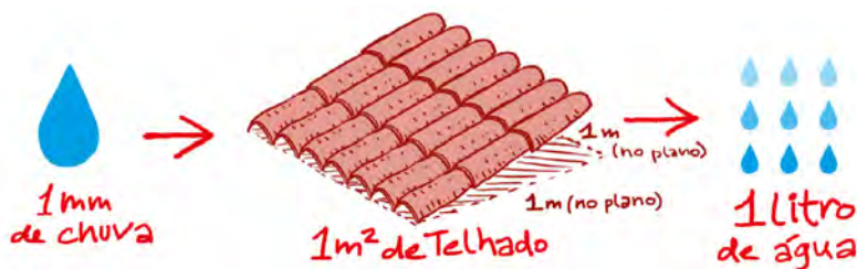
Figura 16 – Quantidade de litros de água captados no telhado por metro quadrado.
