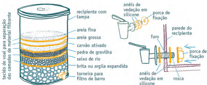
Figura 4 – Esquema do filtro caseiro de água.
