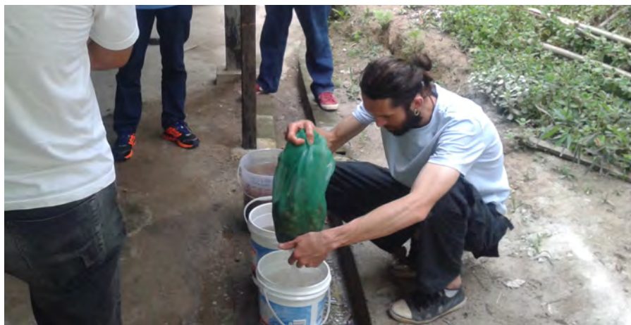
Foto 2 – Lavagem da argila expandida com tela de mosquitoireiro.
