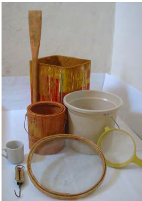
Fotos 39, 40 e 41 – Materiais e ferramentas para a elaboração da tinta de terra.
