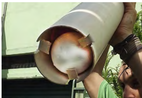
Foto 30 – Detalhe da retenção da bola de isopor com “três garras”.
